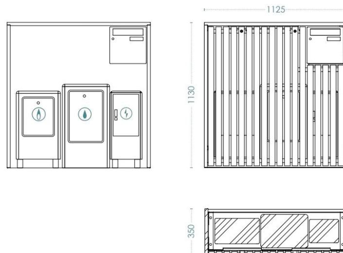
Modèle HOOK de chez Mobilum, choisi pour l'habillage des coffrets. Encadrement béton fibré teinté gris et face arrière béton, face avant en tasseaux bois (douglas, classe naturelle 3.2).
